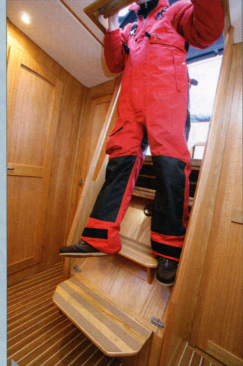
Pas pratique Le chantier a presque pensé à tout, mais les marches de descente ne sont pas recourbées sur les bords.
