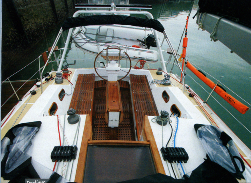
Pratique Pas de fantaisie particulière dans ce grand cockpit, mais une belle table en teck (hélas optionnelle), et aussi des lattes ajourées. Celles-ci ne sont pas seulement esthétiques; elles assurent un drainage plus rapide. A noter que le caillebotis en teck est standard.
