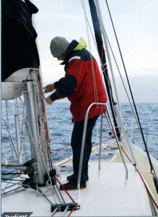
Pratique L'indispensable balcon de pied de mât est livré en standard, de même que les marches de mât permettant d'accéder à la tête.
